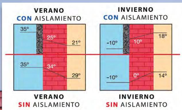
El sistema Ferro-Term es un moderno y novedoso modelo de revestimiento multicapa que actúa como aislante térmico, protegiendo del frío en invierno y del calor en verano. En cuanto a ahorro energético puede suponer hasta un 75% en invierno de menor pérdida de calor y hasta un 25% en verano de menor calentamiento.
